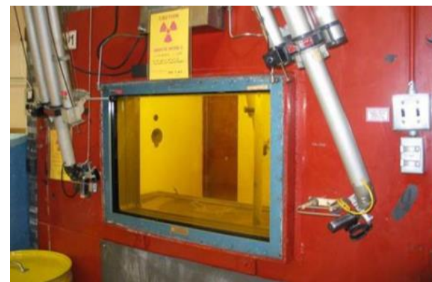
MIT Reactor Hot Cells
