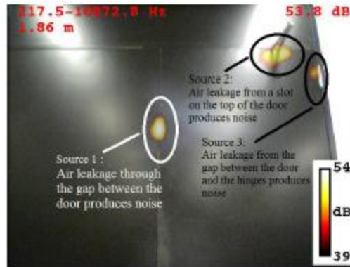
(a) A leaky door
