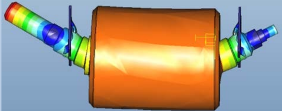
ORNL IM rotor 2780 hz First Bending Mode
