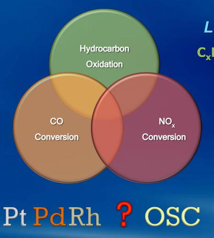
**Engine Operation** Lean Stoic. Rich  $C_xH_v + O_2 \Leftrightarrow CO_2 + H_2O$  $C_xH_v + H_2O \Leftrightarrow CO_2 + H_2$  $CO+O_2 \Leftrightarrow CO_2$  $CO+H_2O \Leftrightarrow CO_2 + H_2$  $NO_x + H_2 \Leftrightarrow NH_3 + H_2O$  $NO_x + CO \Leftrightarrow CO_2 + N_2$ TWC design is critical for PASS
